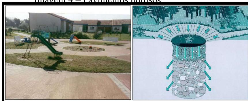
**Imagem 5 – Poços de infiltração**
