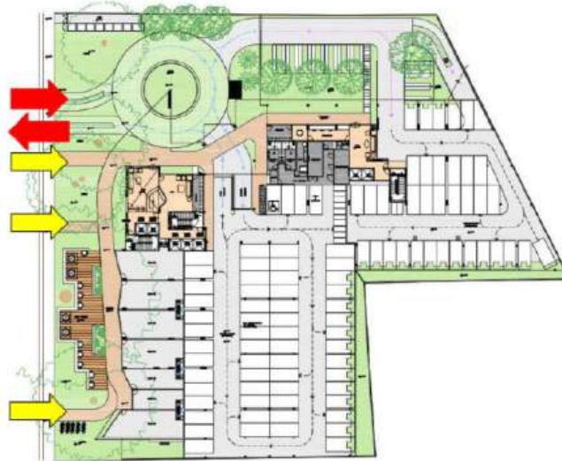
Figura 03 – Planta do pavimento térreo, indicando os acessos ao empreendimento. Veículos (em vermelho), pedestres (em amarelo). Fonte: Estudo apresentado pelo interessado.
