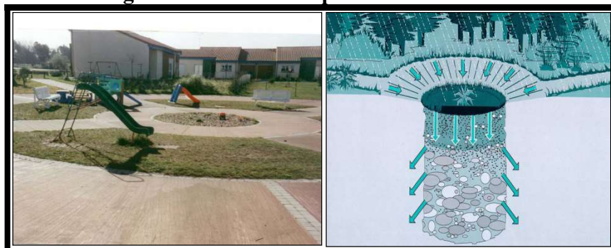
Imagem 5 – Poços de infiltração
