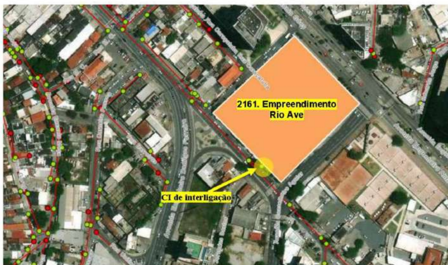
Imagem 3 – Localização da Caixa de Inspeção para interligação
