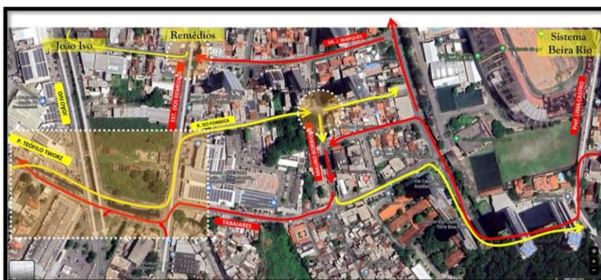
A solução em mão inglesa da R. Padre Teófilo Tworz está detalhada na figura seguinte, com um dimensionamento inicial para a nova ponte que deverá ser implantada na via, além do tratamento a ser dado às interseções da Estrada dos Remédios com a R. Tabaiães e com a R. do Fonseca.
