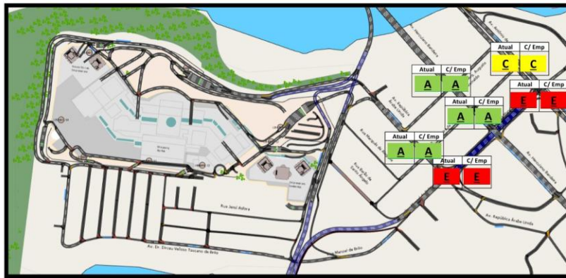
Figura 30: Nível de Serviço no pico da manhã
