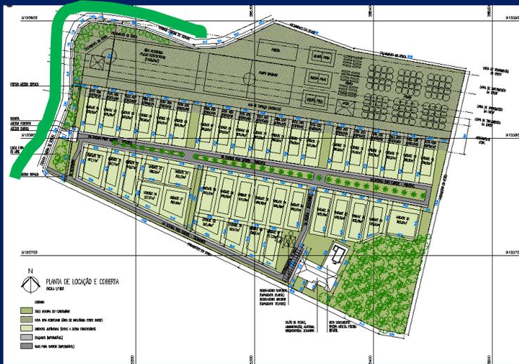
**Aimbê – Faixa de amenização ambiental ao longo da Ladeira do Sereno. Muros recuados com uso de cobogó, e demais trechos em cerca.**
