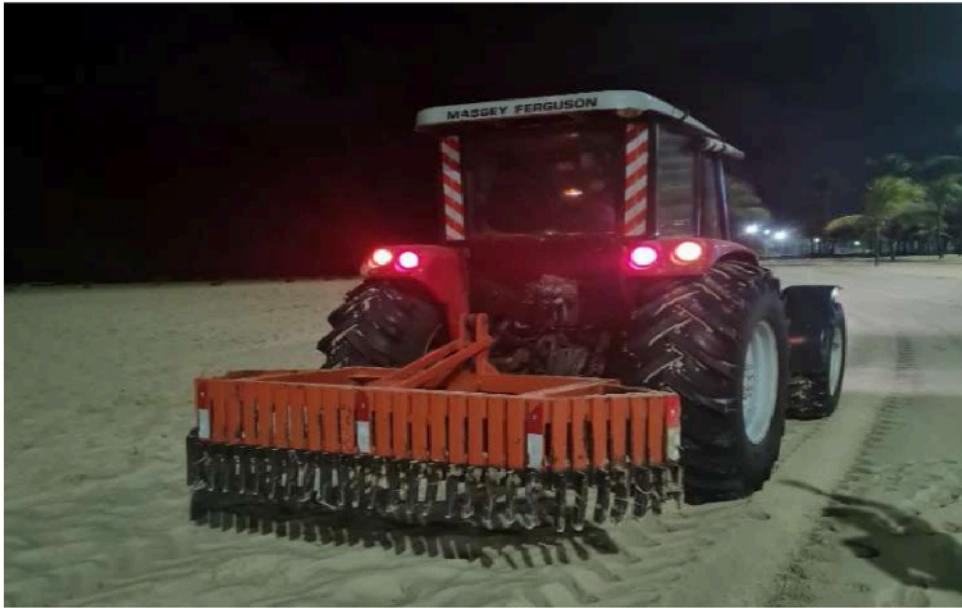
Figura 14: Trator com rastelo para limpeza de faixa de areia mecanizada
