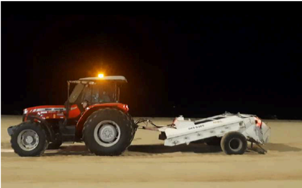
Figura 15: Serviço de limpeza de faixa de areia: trator com equipamento para peneiramento da areia e sucção de resíduos
