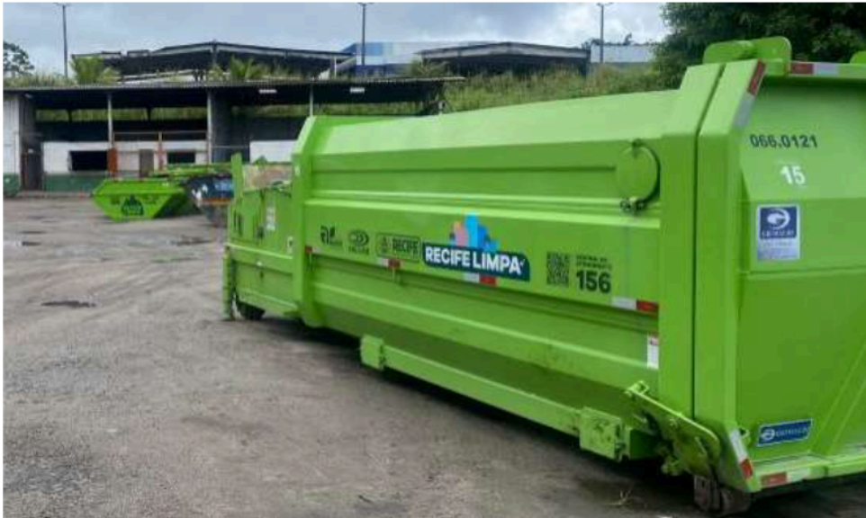
Figura 34: Caixas coletoras compactadoras estacionárias/Recife – PE
