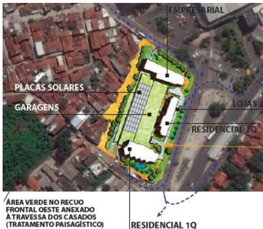
Figura 13 – esquema da implantação da nova proposta para o empreendimento. Fonte: Autor do Projeto
